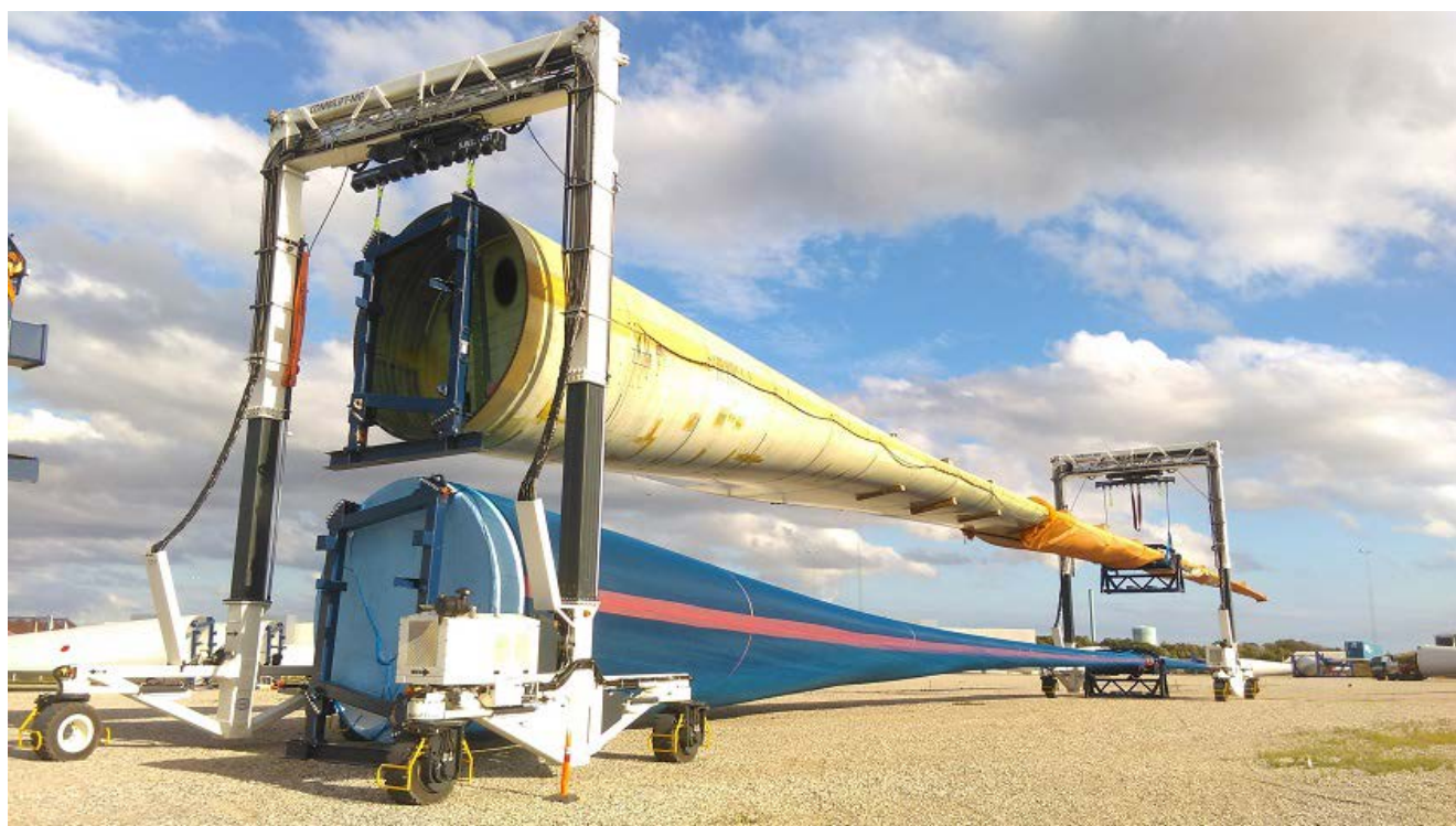
OBERES BILD: 2 COMBi-MG Maschinen transportieren im Tandembetrieb 2 Windturbinenflügel
